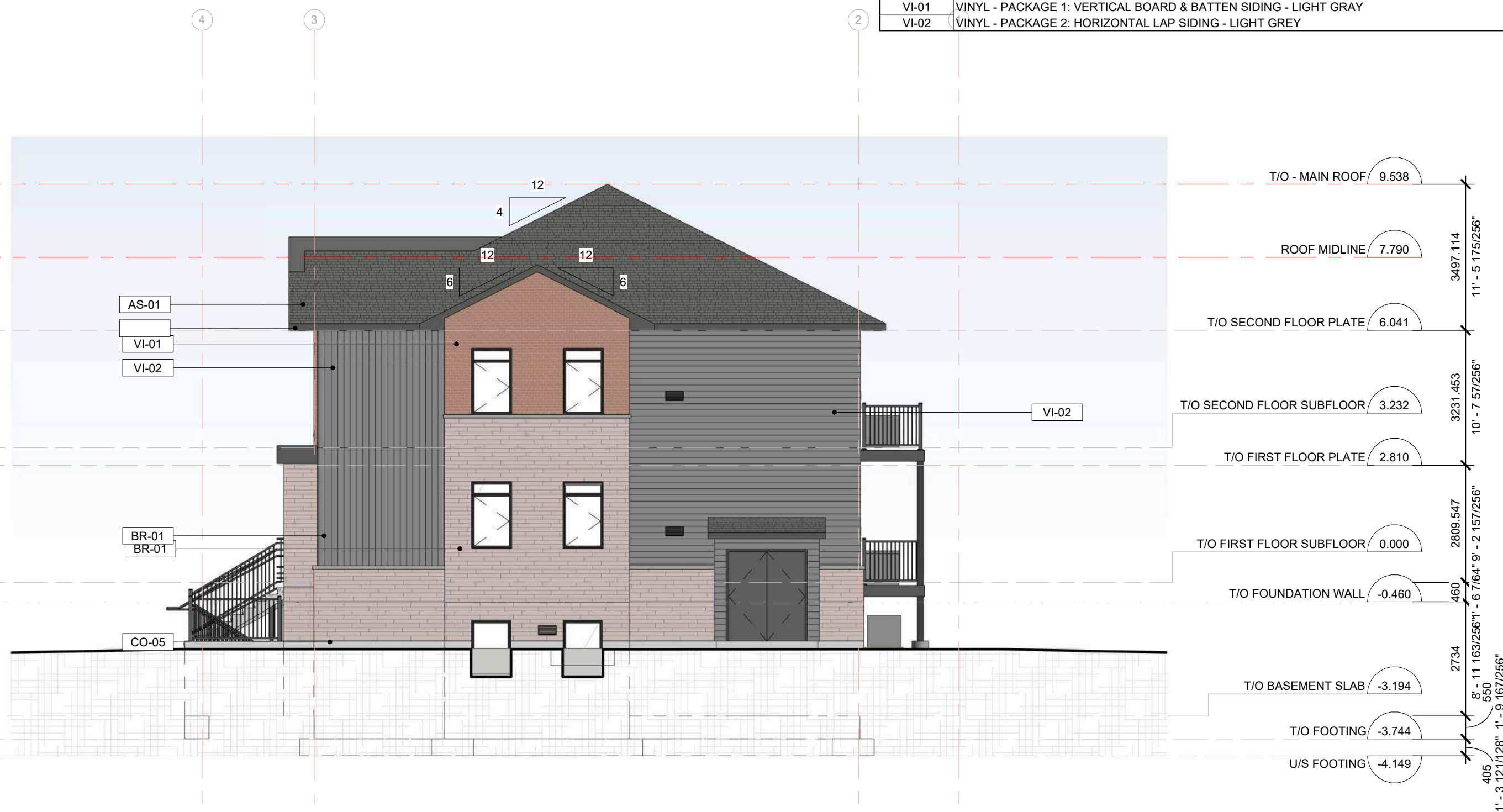
2 RIGHT ELEVATION A202 1:100
