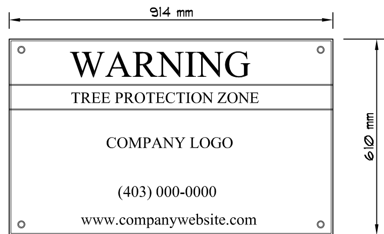
TREE PROTECTION SIGNAGE Scale = N.T.S
