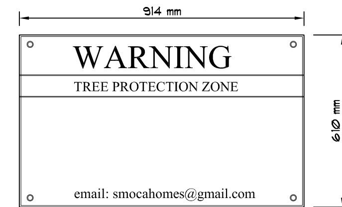
TREE PROTECTION SIGNAGE Scale = N.T.S
