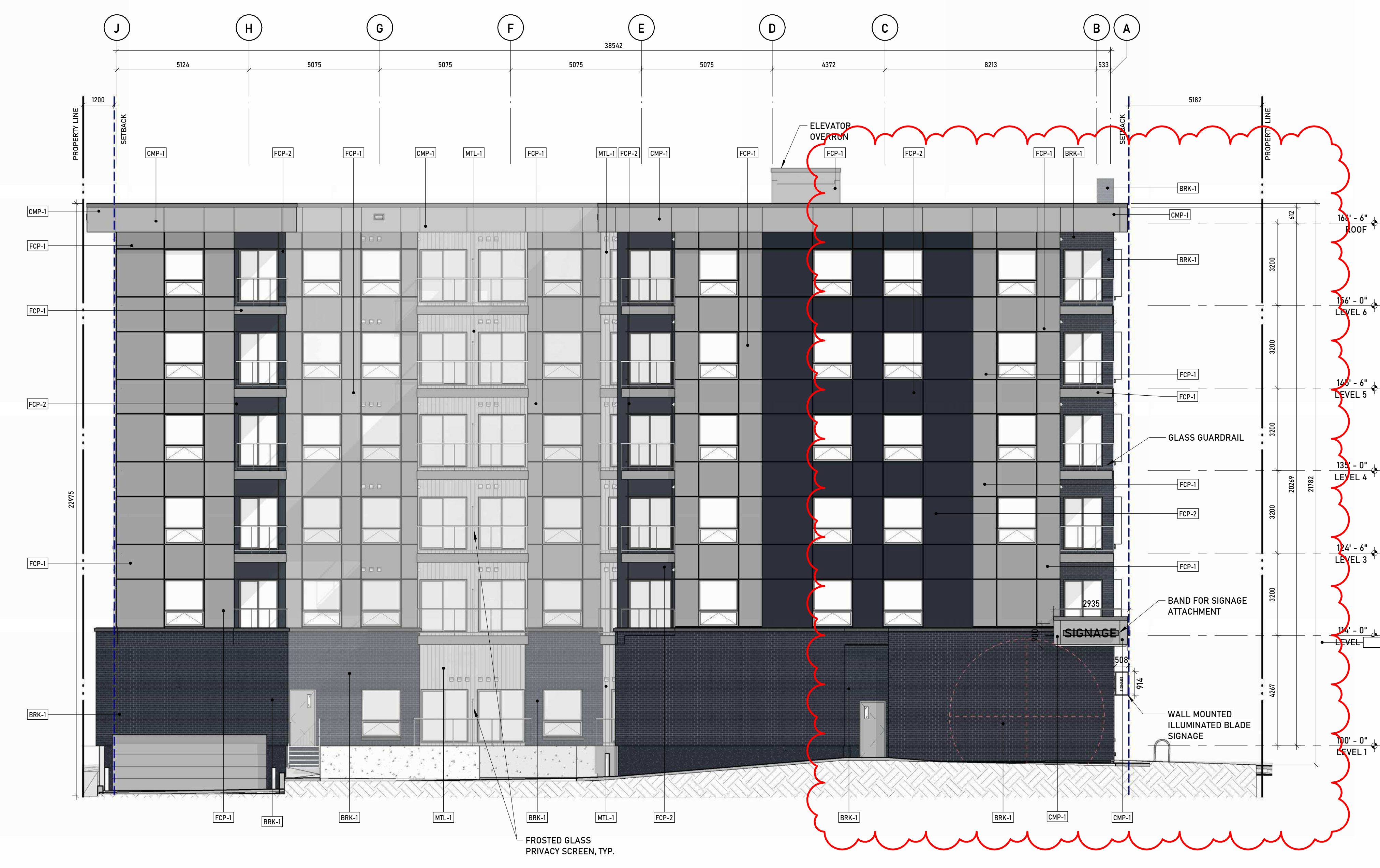
2 EAST ELEVATION SCALE: 1:100
