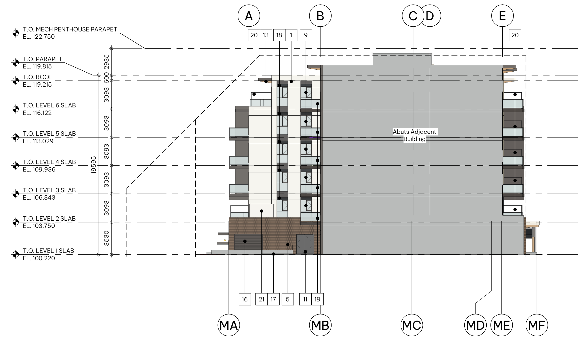
2 DP - West Elevation DP4.01 SCALE: 1:200
