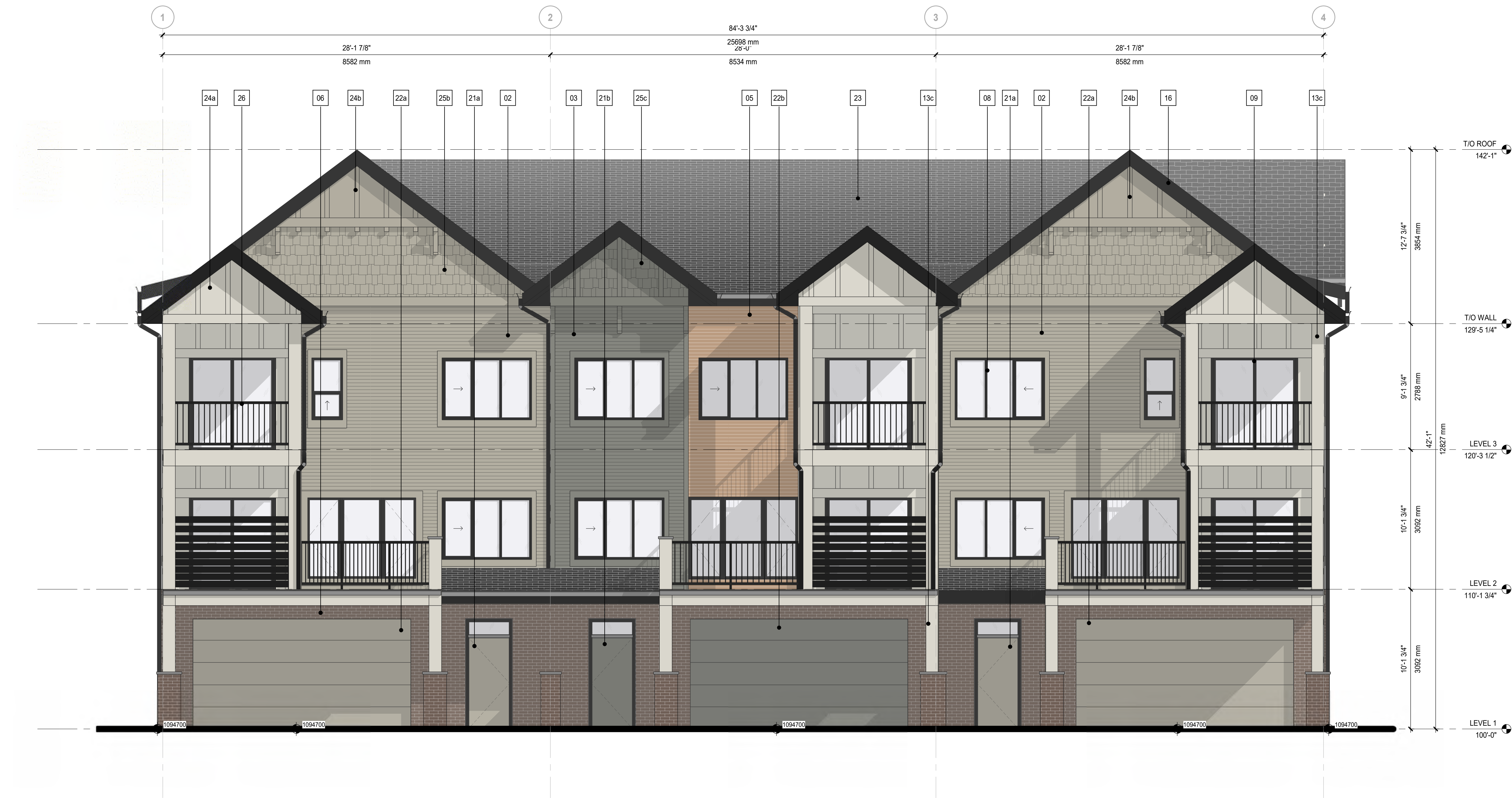
1 Front Elevation A - TH I Scale: 1:50
