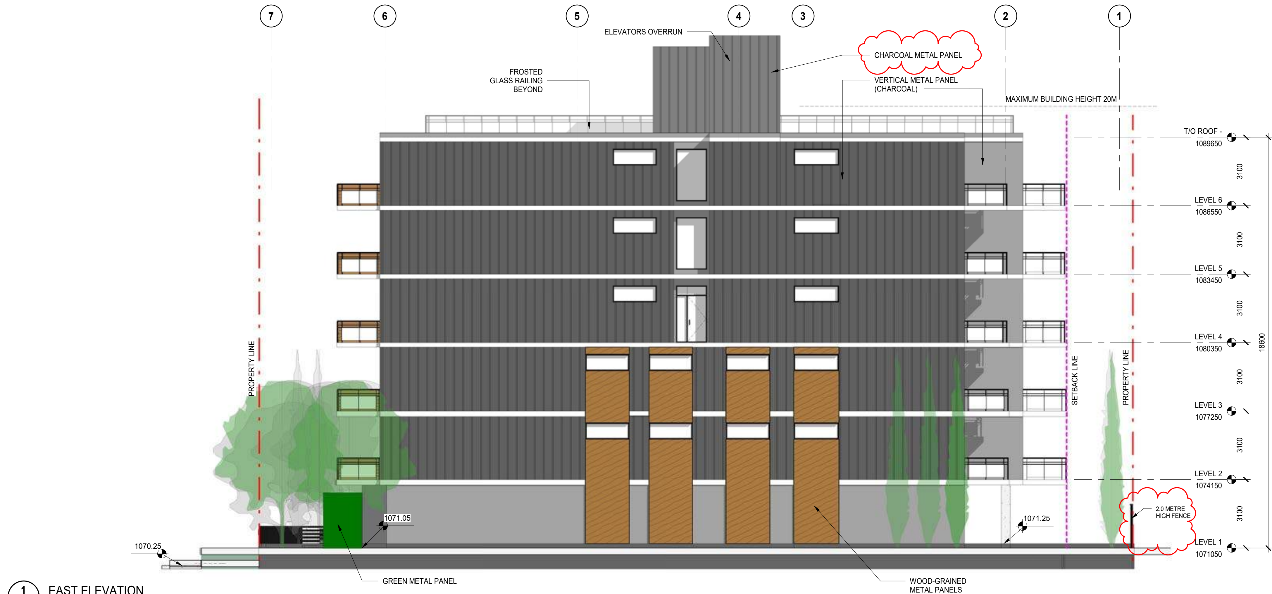
1 EAST ELEVATION A3.01 SCALE: 1 : 100
